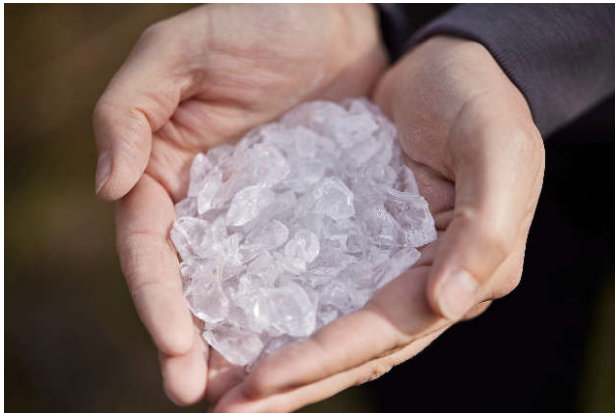
Germaniumhoudend productieschroot van glasvezelkabels
